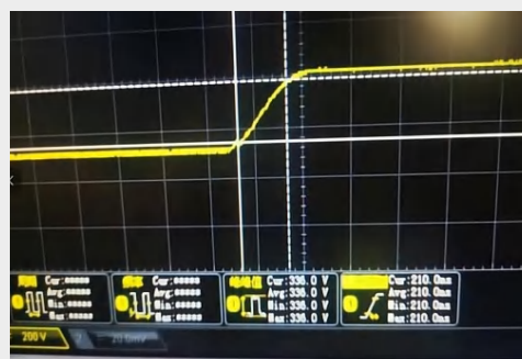
Отфильтрованное значение du/dt: 84.5 В/мкс
