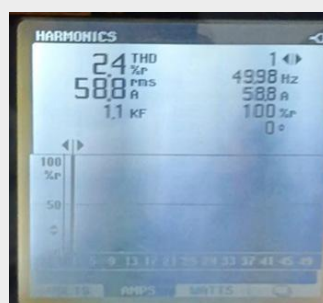
Сигналы напряжения и тока, а также коэффициент искажения тока THD после добавления
