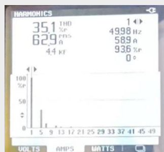
Сигналы напряжения и тока, а также коэффициент искажения тока THD перед добавлением
