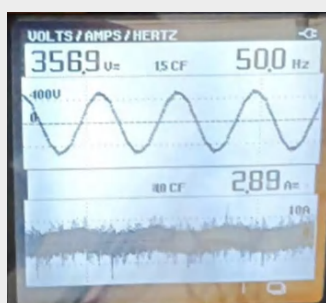
Сигналы напряжения и тока, а также коэффициент искажения тока THD после добавления
